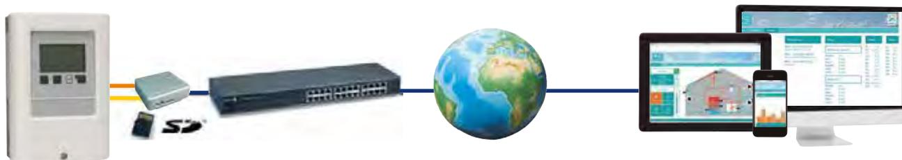
La función "Connect" es un nuevo concepto de instalación "Plug&Play". Usando un interface CAN-bus, los controladores pueden comunicarse entre ellos, o conectarse con redes locales o Internet via Ethernet. El usuario puede monitorizar y controlar su instalación a través del PC, Tablet o Smartphone – en cualquier lugar y momento.
