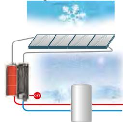
Si no hay radiación suficiente para que el sistema se ponga en marcha, todo el líquido primario está contenido en el depósito Drain Unit (protegido ante heladas).
