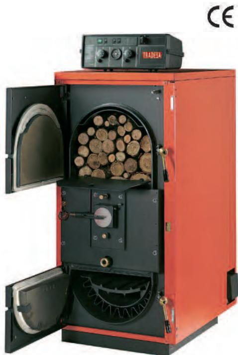
Caldera en acero pirolítica para calefacción a leña. Funcionamiento con gasificación del combustible y llama vertical invertida. Alimentación aspirada con central de ventilación. Espesor hogar 5 mm. Carcasa limitada a los laterales y cubierta.
