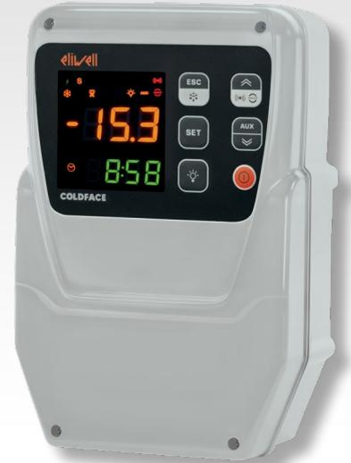
Soluciones Integrales que combinan utilidades como la alarma de persona encerrada con señalización óptica y acústica, detección de fugas de gases, termómetro metroológico, registro de eventos HACCP con calendario anual, Pump Down, desescarches programados, cuadro eléctrico completo, detección y señalización con instalaciones con dos circuitos refrigerantes con diferente tipos de gas, telegestión, etc.
