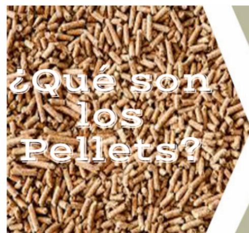
Piezas prensadas cilíndricas y normalizadas, de madera natural y sin tratar
