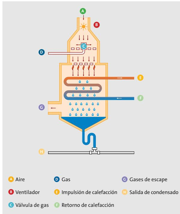
Fig. 30: Esquema de un aparato de condensación
