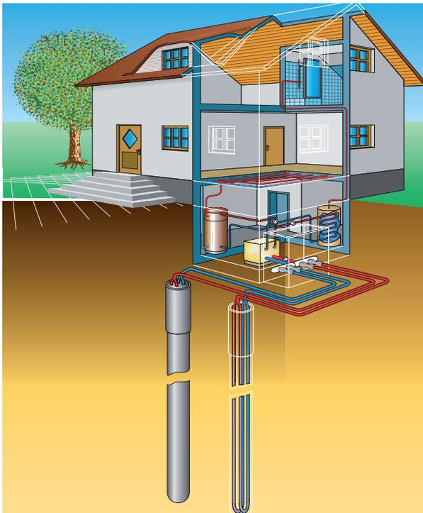
Fig. 44: Bomba de calor geotérmica con sondas verticales
