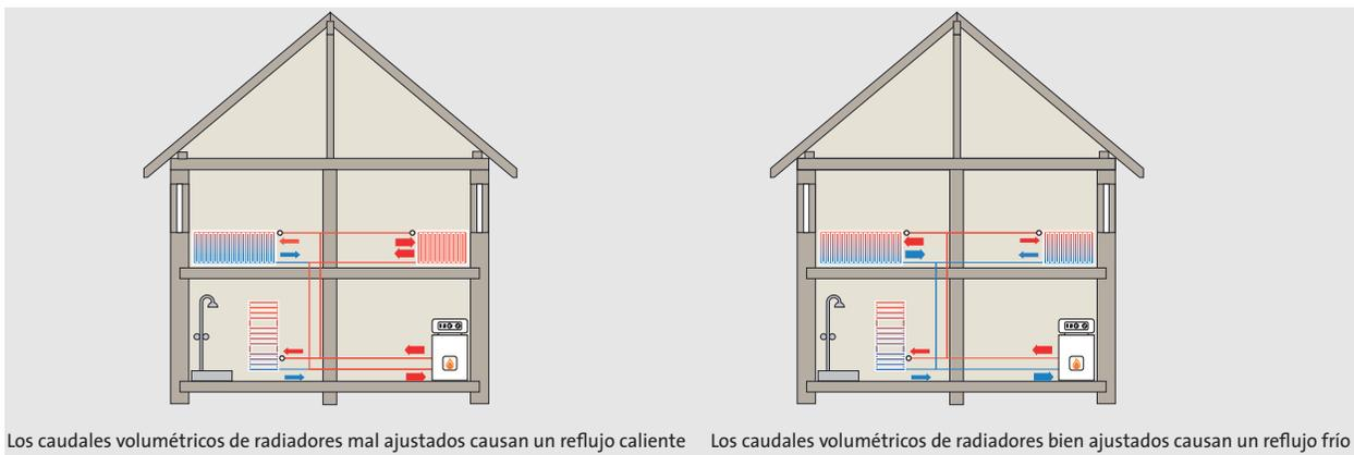
Fig. 68: Balance hidráulico
