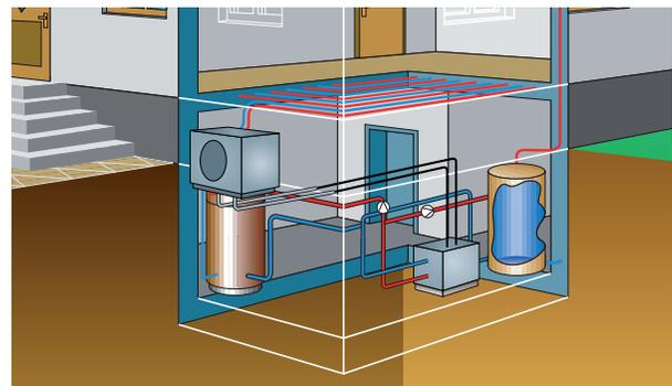
Fig. 46: Bomba de calor aire-agua como sistema split
