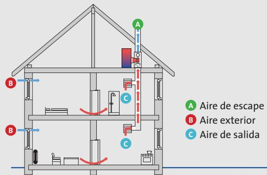
Fig. 82: Instalación de salida de aire centralizado con bomba de calor
