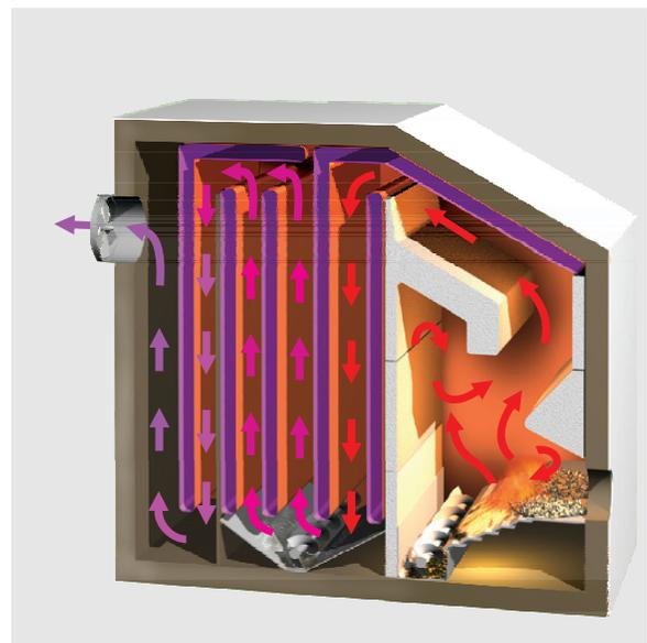
Fig. 61: Sección de una caldera de madera triturada
