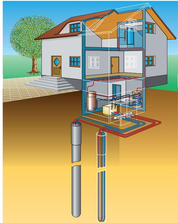
Fig. 42: Bomba de calor geotérmica con sondas verticales
