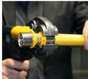
**Paso 4:** realizar el apriete con la prensa, utilizando mordazas tipo "TH". Se coloca la mordaza del diámetro correspondiente sobre el anillo plástico portacasquillos para fijar la posición y se realiza el apriete hasta que la mordaza está en posición totalmente cerrada.
