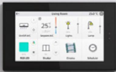
El control de los equipos instalados en las viviendas es cada vez más inteligente y centralizado. Esto es posible gracias a distintas tecnologías, entre la que destaca la tecnología KNX, un estándar ideado para el control o automatización de hogares y edificios inteligentes. Este protocolo, ofrece una enorme cantidad de funcionalidades compatible con miles de familias de productos, sea cual sea el fabricante. Laboratorios de ensayo externos certifican, además, la conformidad de estos sistemas.
