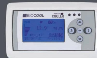
AVANZADO SISTEMA DE CONTROL DE HASTA 10 UNIDADES QUE PERMITE SU CONEXIÓN A RED LOCAL PARA ACCEDER AL WEBSERVER INTERNO ADEMÁS DE PERMITIR CONECTARLO A SENSORES DE TEMPERATURA Y HUMEDAD TANTO AMBIENTE COMO EXTERIOR
