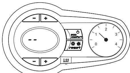
fig. 7 - Apagado de la caldera
