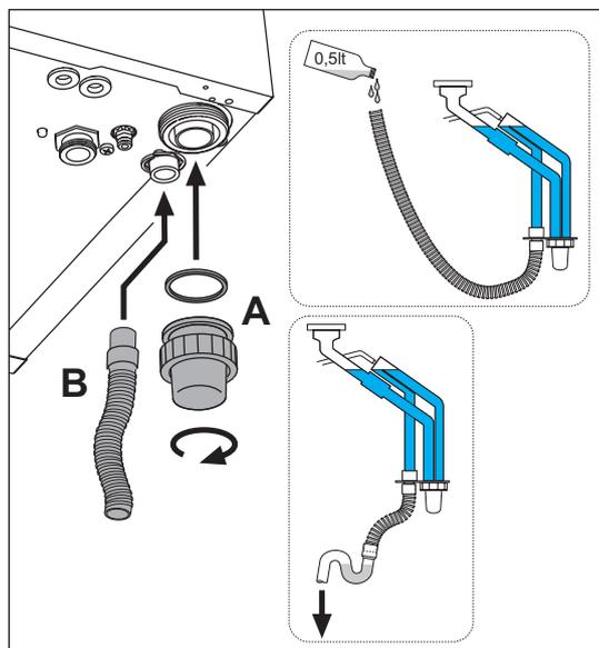
fig. 20 - Conexión de la descarga de condensados
