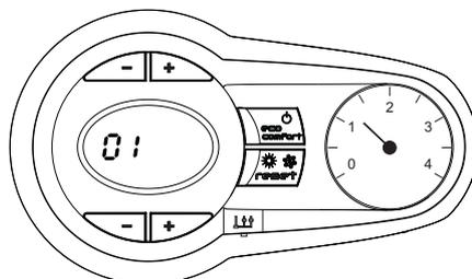
fig. 5 - Encendido / Versión del software
