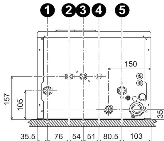
fig. 13 - Conexiones hidráulicas
