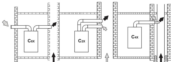
fig. 19 - Ejemplos de conexión a chimeneas (⇨ = aire / ⇩ = humos)
