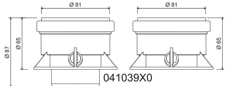
fig. 18 - Accesorio inicial para conductos separados
